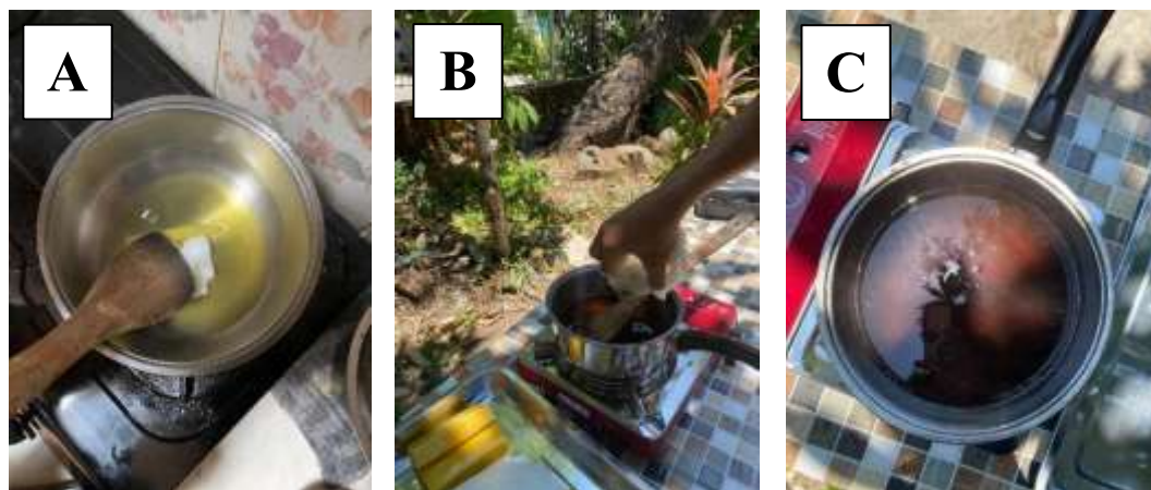
Gambar 2. Pencairan beeswax dan damar (A); Mencampurkan minyak maggot (B); Hasil formulasi lilin batik minyak maggot (C)
