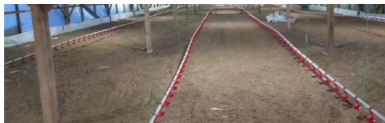
Gambar 2. Instalasi Air Minum Menggunakan *Nipple Drinker*
