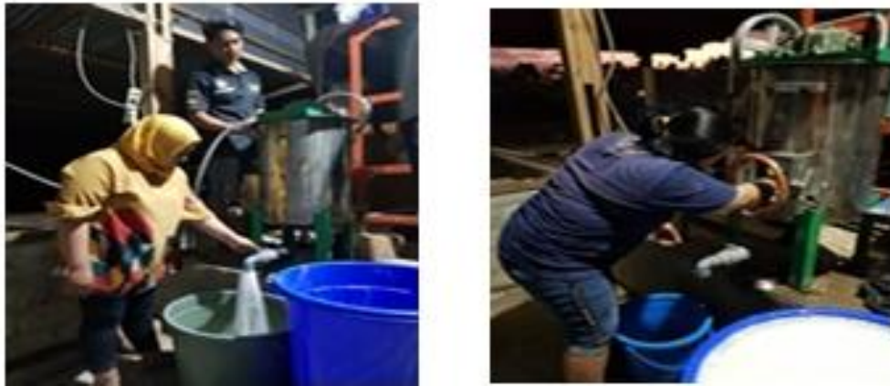
Gambar 7. proses mengalirkan suspensi pati (kiri) dan proses mengeluarkan ampas dari tabung ekstraksi (kanan)
