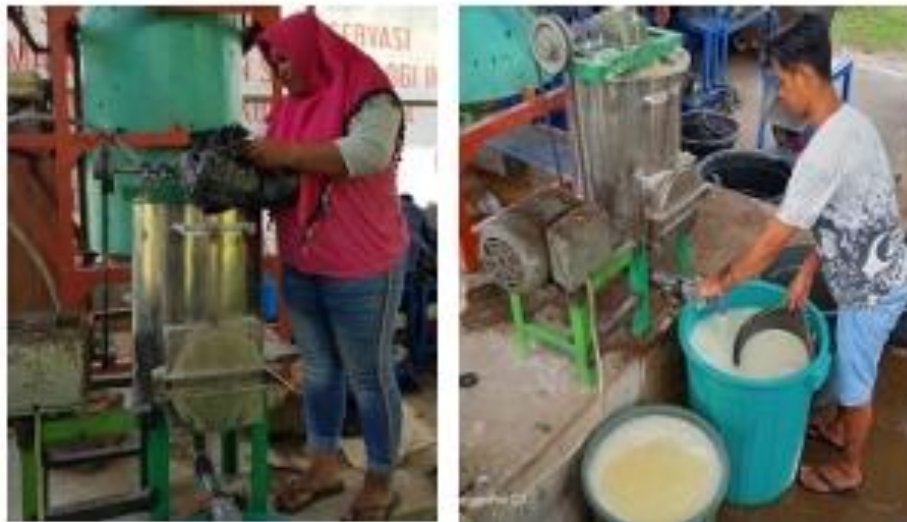
Gambar 4. Pengoperasian mesin ekstraksi pati singkong tipe vertical stirrer rotary blade bertenaga motor listrik, diawali dengan input bahan ke dalam tabung ekstraksi (kiri) dan Dilanjutkan dengan mengalirkan suspensi pati (kanan)
