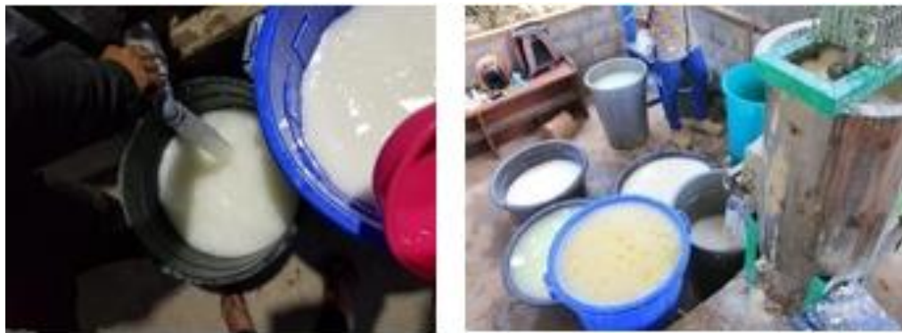
Gambar 10. Suspensi pati pada wadah pengendapan dibiarkan selama 3 jam
