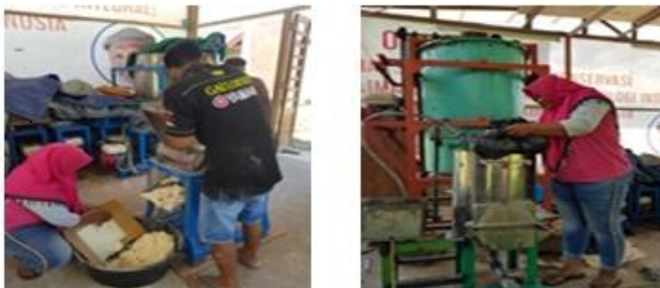
Gambar 6. Proses pamarutan singkong (kiri) dan proses memasukkan parutan umbi ke dalam tabung ekstraksi (kanan)
