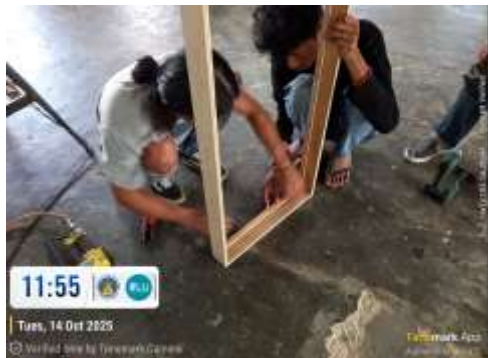
Gambar 15. Penempelan multipleks 12mm dengan 9mm
