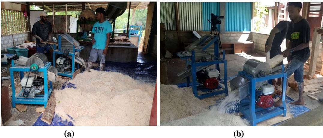
Gambar 3. Proses pamarutan empulur batang sagu menggunakan mesin parut sagu tipe silinder variant-02 (a) dan variant-01 (b)
