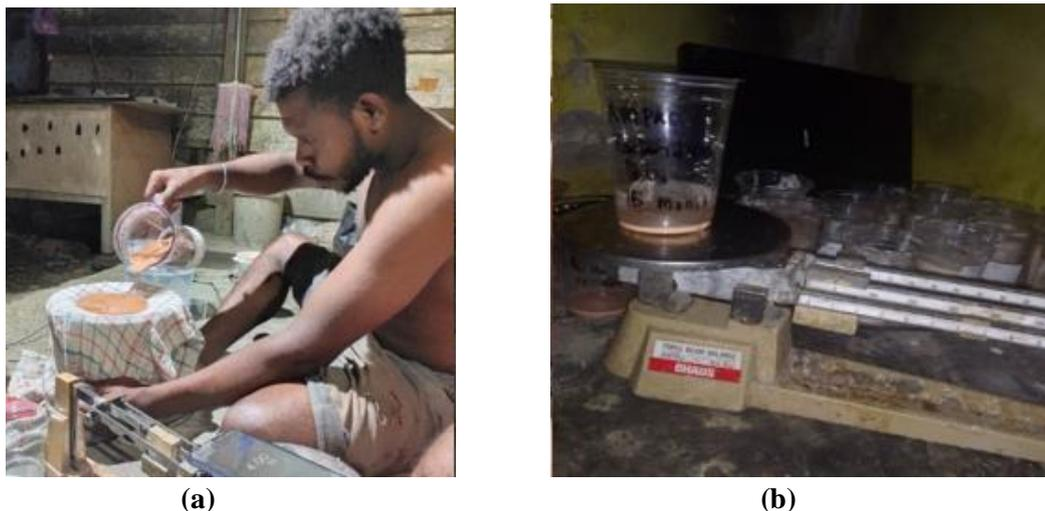
Gambar 6. Re-ekstraksi pati pada ampas setelah diblender (a) dan penimbangan pati hasil re-ekstraksi dari ampas (b)
