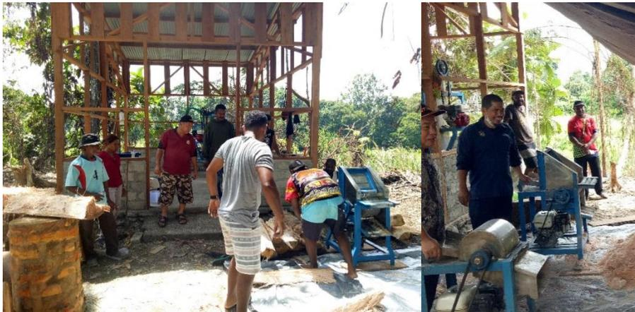
Gambar 1. Mesin parut sagu tipe silinder variant-01 dan variant-02 di tempat pengolahan
