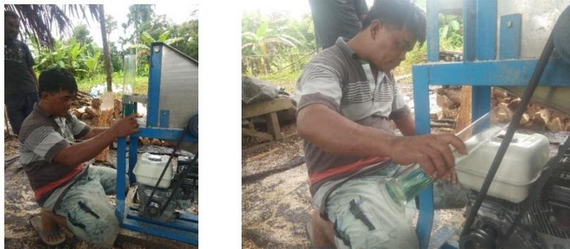
Gambar 7. Pengukuran pemakaian bahan bakar bensin menggunakan gelas ukur
