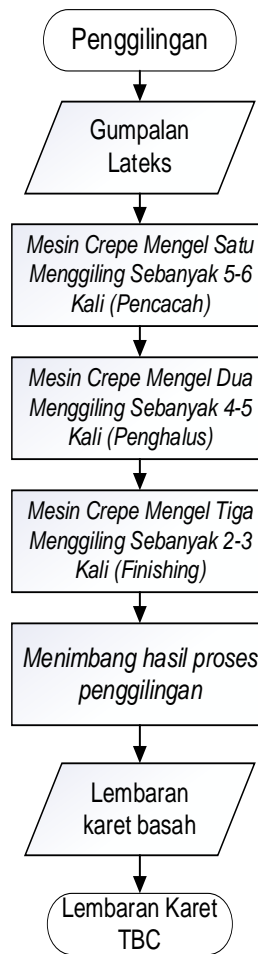
Gambar 1. Diagram alir proses penggilingan karet TBC
