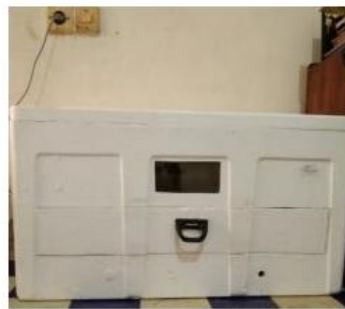
Gambar 2: Mesin tetas dari setirofoam sudah jadi.
