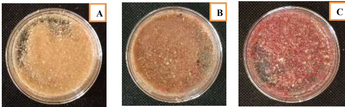
Gambar 4. Foto hasil uji Floroglusinol pada dedak A. Hasil citra digital persentase warna merah 10,77%; B. Hasil citra digital persentase warna merah 26,36%; C. Hasil citra digital warna merah 39,79%
